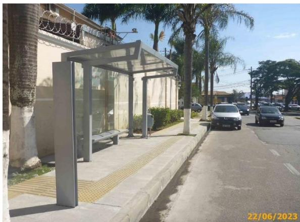
Foto 4 – Vista geral dos equipamentos do abrigo (cobertura, vedações com vidros, banco, totem e lixeira).
